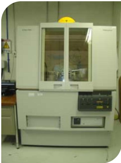
Diffractómetro de Rayos X, Xpert MPD Phillips.  $\theta - 2\theta$ ; Diffractómetro de Rayos X D5000 Siemens ( $\theta - \theta$ ) con cámara de baja y alta temperatura; (-168°C a 1600°C) y detector de posición (12 grados simultáneos); Espectrómetro de Fluorescencia de Rayos X PW2400 Phillips.
