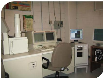
Microscopio Electrónico de Barrido, Marca: JEOL, modelo: JSM 5800-LV; Sistema de microanálisis marca EDAX modelo DX prime;
